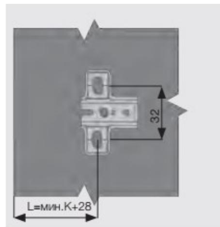
\*Расстояние составляет 37 мм или 28 мм от края боковой стенки накладной двери до отверстий монтажной планки.
