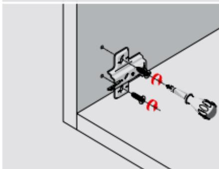
С помощью винтов зафиксируйте
